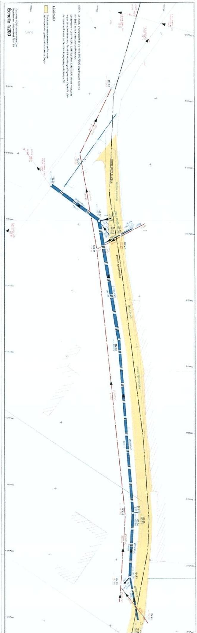
NOTE: Le relevé a été effectué de nuit avec un DTM 2000 et un niveau automatique. Les points de mesure ont été matérialisés par des bornes en bois. Les points de mesure sont indiqués sur le plan par des symboles appropriés. Les points de mesure sont indiqués sur le plan par des symboles appropriés. Les points de mesure sont indiqués sur le plan par des symboles appropriés.
